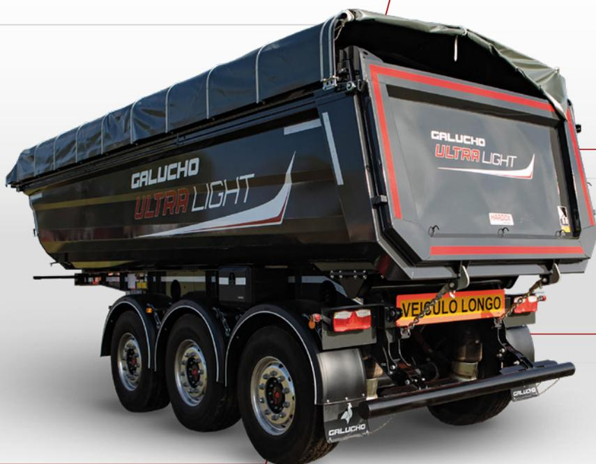
**ULTRA LIGHT** | SEMIRREBOQUE BASCULANTE DE 3 EIXOS.
